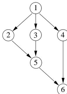
1. Donner une solution utilisant les sémaphores pour synchroniser ces processus de manière à respecter les contraintes de précédence (on ne demande pas de code C, mais un
